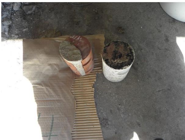
Kuva 6.1 Sokkelin pikisively, ei sisällä asbestia
