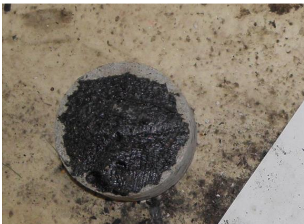
Kuva 6.1 Sokkelin pikisively ei sisällä asbestia
