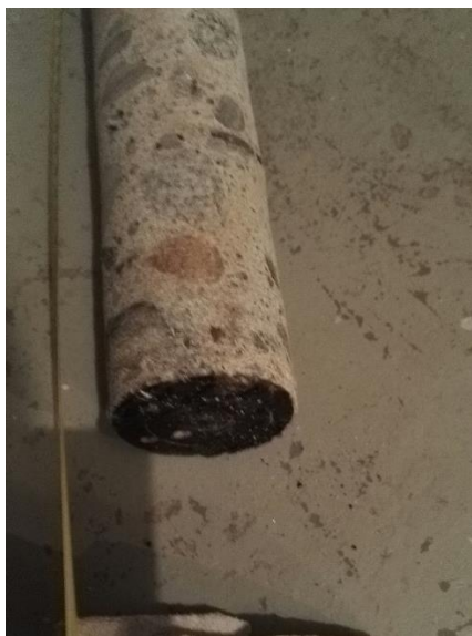
Kuva 6.1 Kellarikerroksen perusmuurin pikisivelyn PAH-pitoisuus ei ylitä vaarallisen jätteen raja-arvoa.
